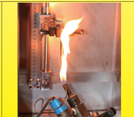
Образец во время испытания на UL94VO
