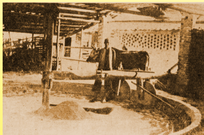
Измельчение каолина шлифовальными камнями, приводимыми в действие с помощью вола (1939 г., Вьетнам, «Экономический бюллетень Индокитая»)
